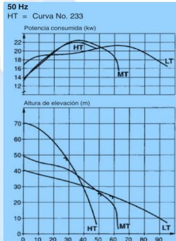
**Motor eléctrico de 20kW a 2930rpm con aislación clase F (155°C), para corriente alterna trifásica 380 50 Hz, arranque tablero de control estrella - triángulo.**
